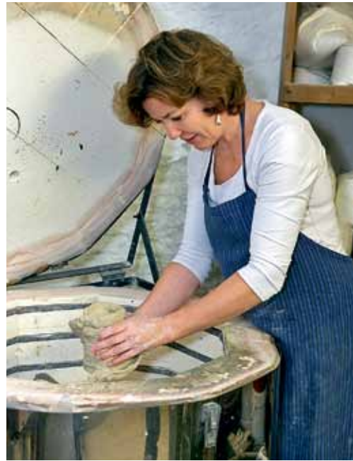
Bei etwa 900 bis 950 °C wird der Ton gebrannt ... und danach glasiert.
