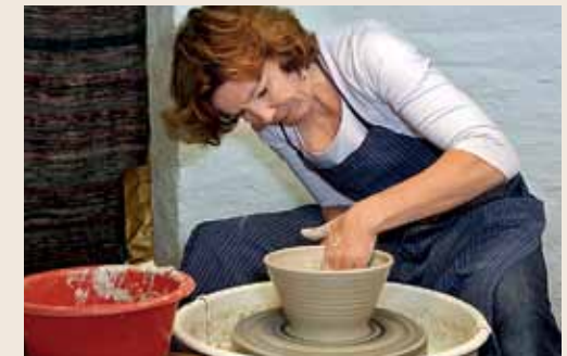
Man braucht Fingerspitzengefühl und Übung, um den Ton hochzuziehen und der Schale eine gleichmäßige Form zu geben.
