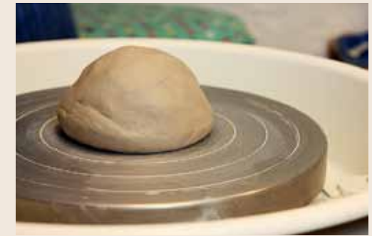
Beim Drehen auf der Töpferscheibe wird der Tonklumpen fest in der Mitte der Scheibe platziert.
