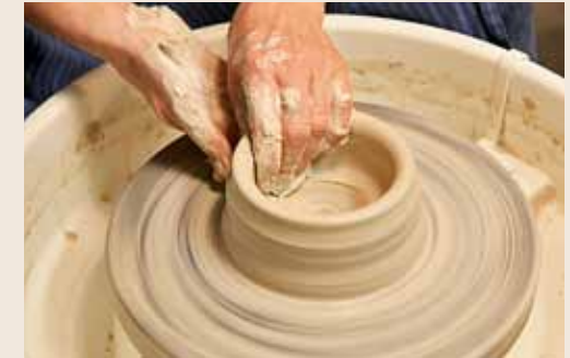
Die Hände werden befeuchtet, bevor der Ton „aufgemacht“ wird. Dafür ist viel Übung nötig.
