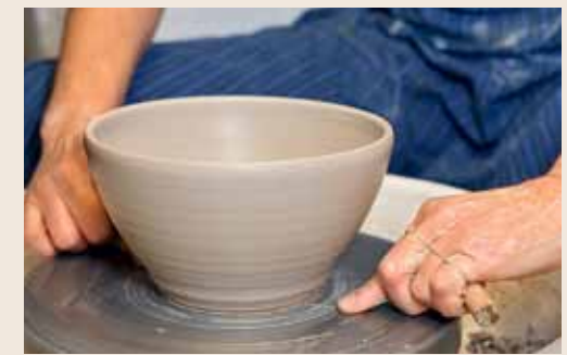
Die fertige, noch feuchte Schale wird mit einem Schneidedraht von der Drehscheibe gelöst.
